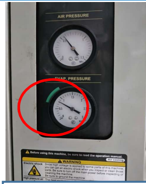
Bước 3: Kiểm tra áp suất gas tĩnh của máy sấy khí
